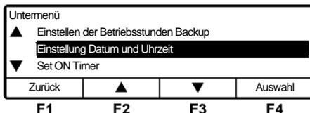
**4** Drücken Sie die Taste „F4 (Auswahl)“, um in den Modus „Einstellung Datum und Uhrzeit“ zu wechseln (Abbildung rechts).
