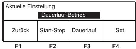
**3 Drücken Sie den Schalter „F2 (Start-Stop)“ oder „F3 (Dauerlauf)“, um den automatischen Start/Stop-Betrieb oder den Dauerlauf-Betrieb auszuwählen.**
